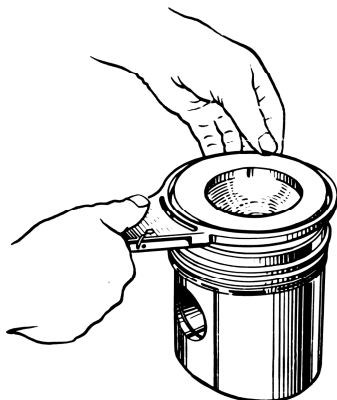
Рис. 95. Снятие и надевание поршневых колец на поршень
